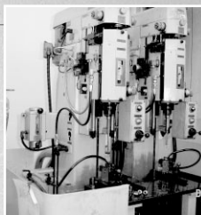
NISSIN 迷你塘孔機, 利用砥石自動加工零件至所需精度, 達到 \mu 級水準
